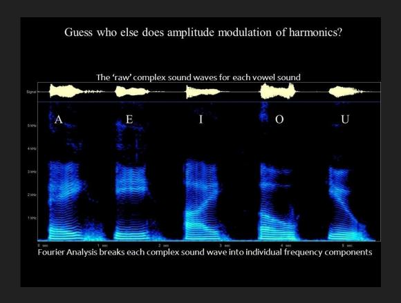
En la etapa de <u>extracción de propiedades</u> calculamos las dos frecuencias predominantes (formantes) del espectro anterior. El flujo continuo de voz recogido por el micrófono se transforma en una nube de puntos dentro de un espacio vectorial bidimensional.
