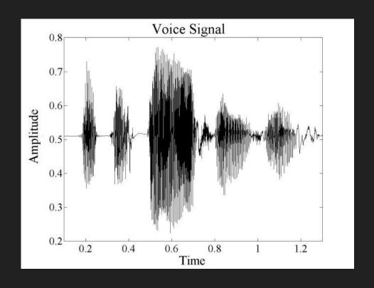
Transformamos cada trozo elemental de sonido al dominio de la frecuencia, calculando su transformada de Fourier y manipulándola adecuadamente para obtener el espectro de frecuencias, que proporciona información relevante sobre la naturaleza del sonido (timbre, armónicos, etc.).
