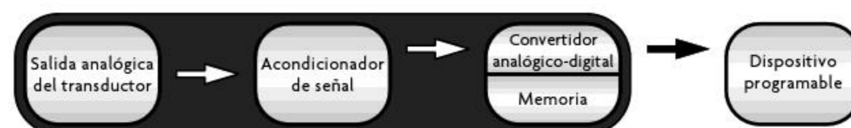
Figura 1.37 Cuarto modo de integración de un sensor inteligente.
