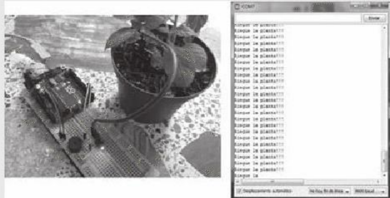
Figura 6.62 Humedad menor al límite, entonces se emite alerta por el monitor serie y el buzzer.
