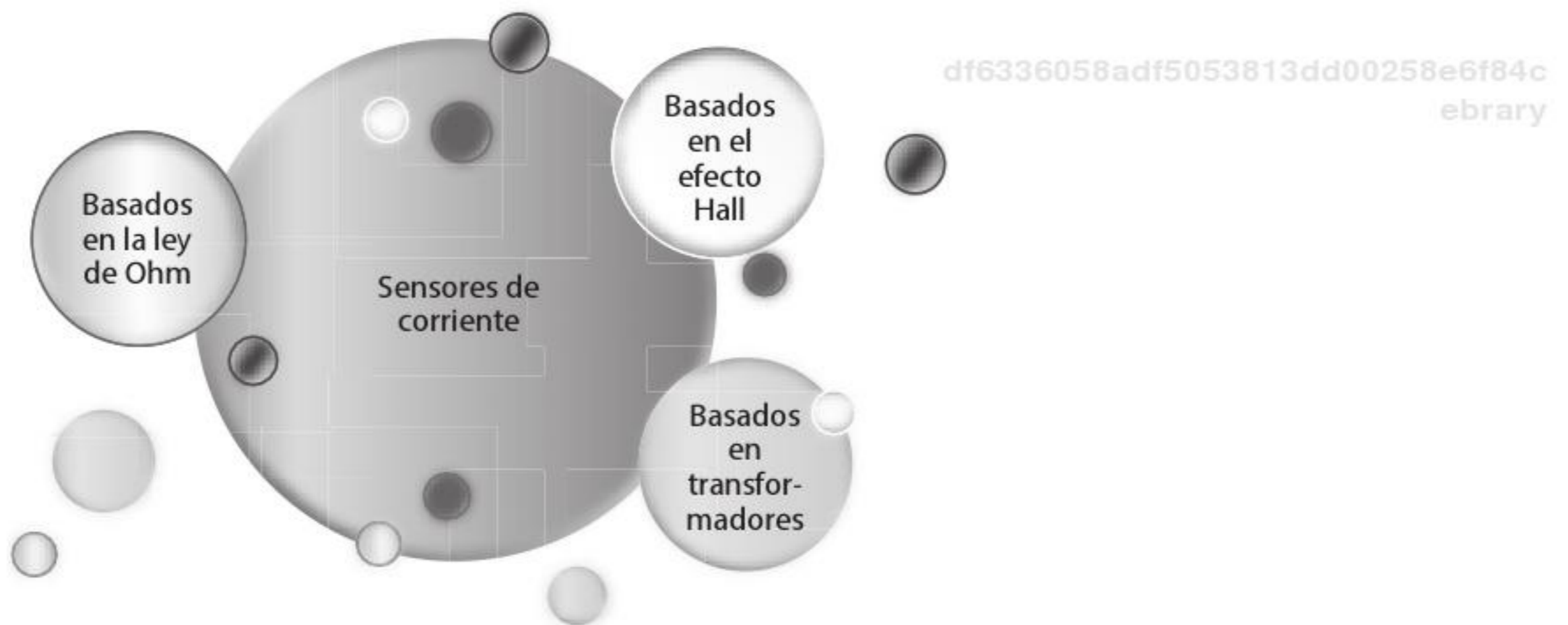
Figura 9.14 Clasificación de sensores de corriente.
