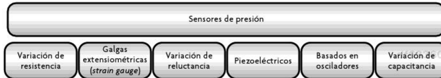
Figura 8.4 Clasificación de sensores de presión por su principio de transducción.
