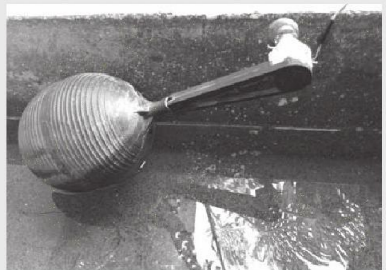
Figura 5.25 Flotador acoplado al potenciómetro.
