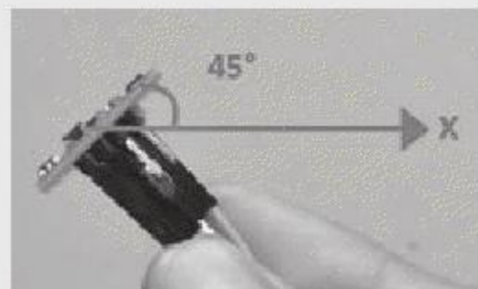
Figura 3.62 Medición de la inclinación a 45° en el plano XZ.
