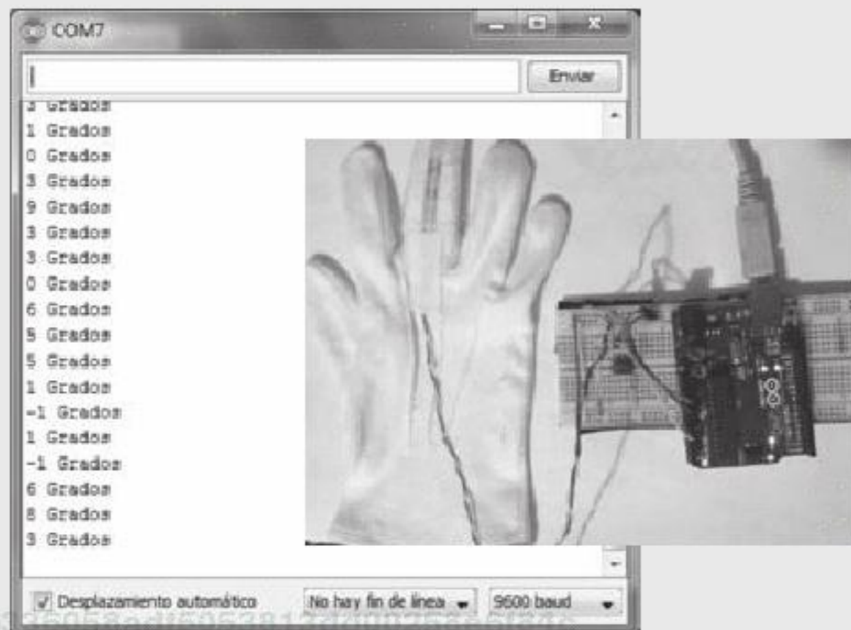
Figura 7.45 Cuando el flex sensor está plano por completo (0°) indica una lectura promedio de 3 grados.
