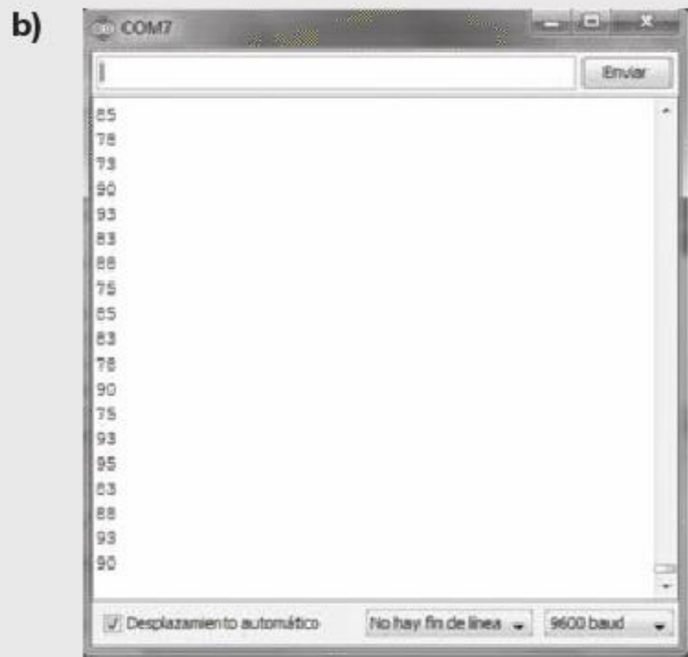
Figura 3.29 a) Objeto colocado en una posición de 90° aproximadamente. b) La lectura, a pesar de ser un poco errática, también ronda los 90°.
