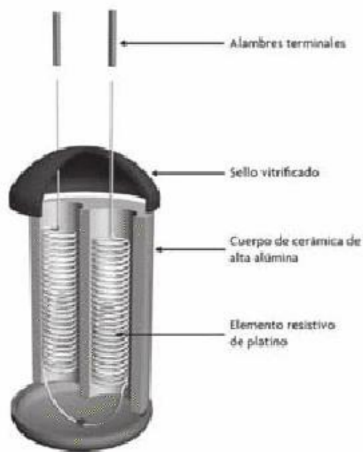
Figura 6.20 Dispositivo RTD de bobina o alambre enrollado.
