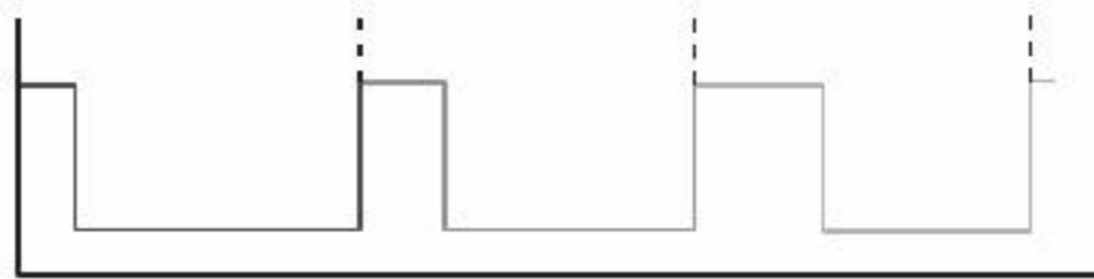
Figura 10.15 PWM para recorrer todo el rango de operación del servomotor.
