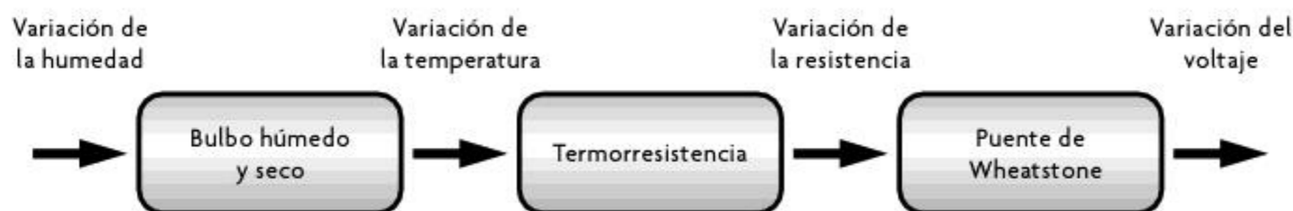
Figura 6.55 Diagrama de las variables que intervienen en una medición.
