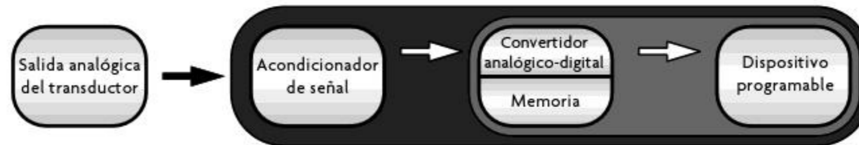
Figura 1.35 Segundo modo de integración de un sensor inteligente.
