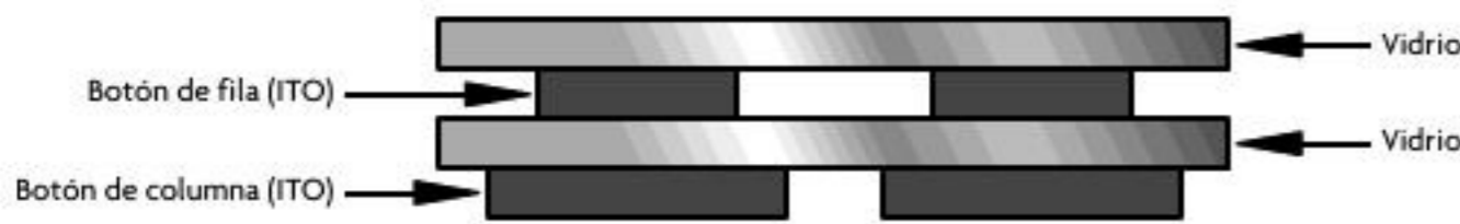
Figura 5.45 Arreglo para paneles de alta resolución.
