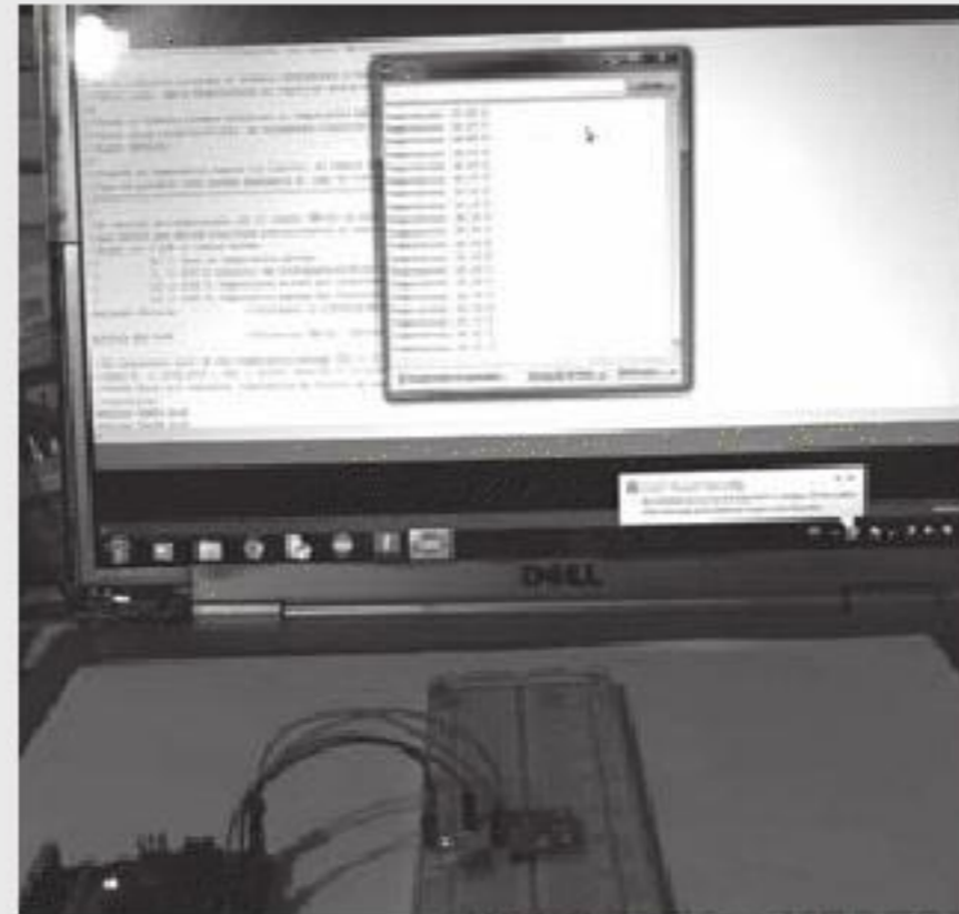
Figura 6.47 Cuando la temperatura supera el límite máximo se activa la alarma, hasta que esta vuelva a descender más allá del límite inferior. En la imagen se observa cómo se ha activado la alarma, pues por un momento la temperatura sobrepasó los 30 °C, y a pesar de estar ya en 28 °C, la alarma no se desactiva hasta bajar a menos de 25 °C.
